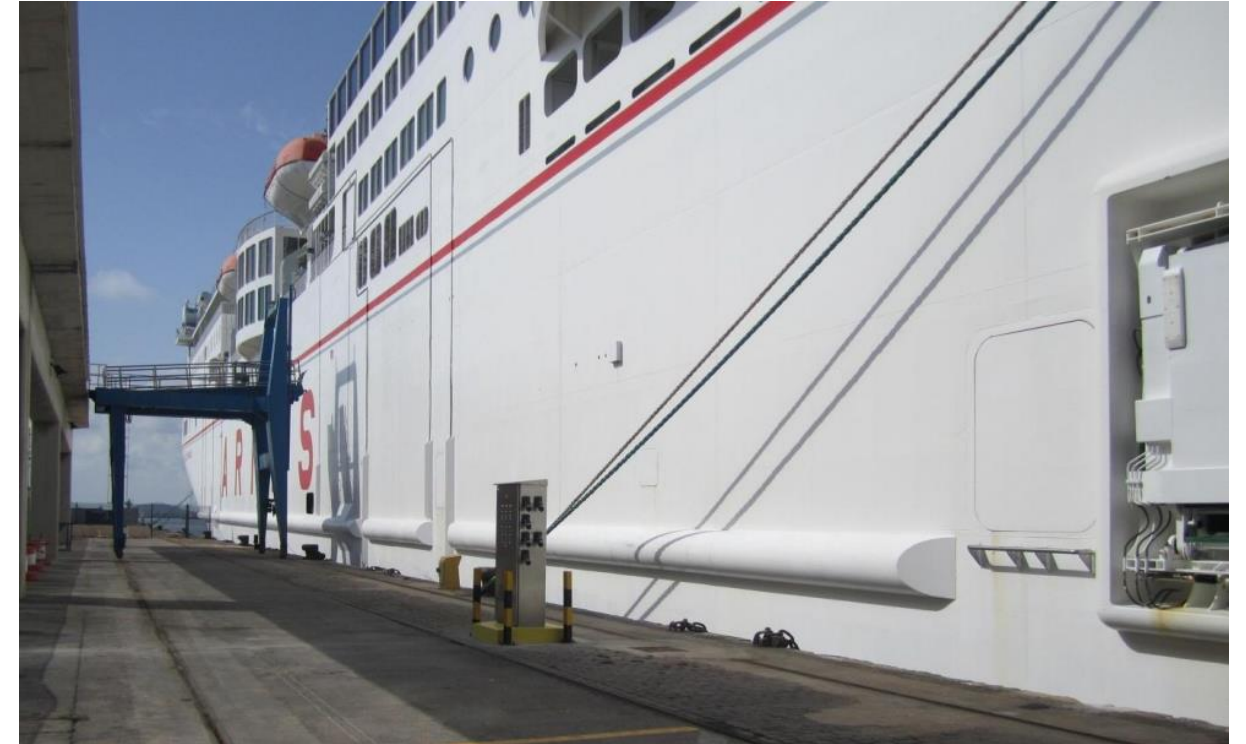
Figura 14: Buque de Naviera Armas atracado en el muelle Espigón, junto a terminal de conexión eléctrica
